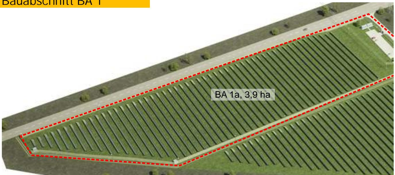
Im Bauabschnitt (BA 1a) entsteht eine Freiflächen PV Anlage mit einer Nennleistung von 1,4 MWp auf einer Grundstückfläche von 3,9 ha.
